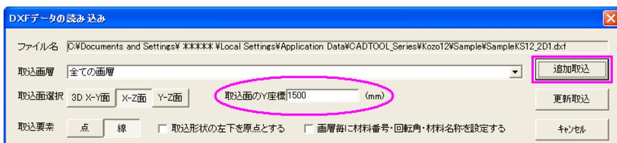
Y座標が1500の位置のX-Z面に2次元のDXF形状が取り込まれる
