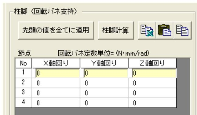
ただし柱脚の回転バネ定数は基礎の寸法やアンカーの数などから求めるものなので、あらかじめ求めておかないと入力できません。そこで「フレーム構造解析 10」から専用のダイアログをつかって回転バネ定数を比較的簡単に求めることができるようになっています。
