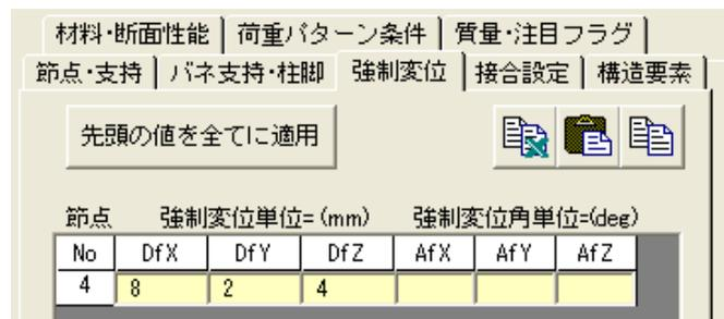
強制変位とは特定の節点を設定した変位量だけ強制的に動かすもので、動かしたい変位や変位角を入力します。
