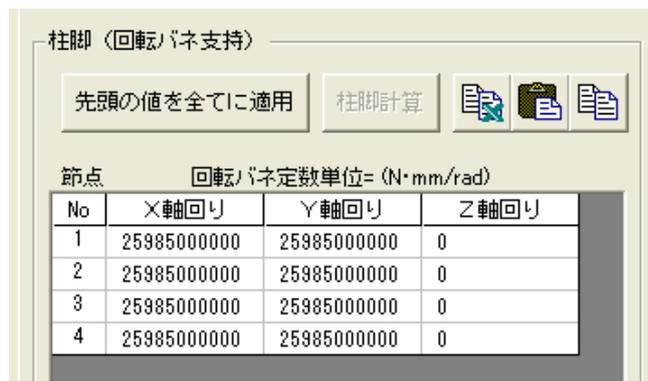
上に回転バネ定数を設定した例を示しますが、この回転バネ定数の単位は [計算条件・単位設定] で設定している荷重および長さの単位が使われます。ただし角度はラジアン (rad) で固定です。ではこの条件で [計算実行] ボタンをクリックして計算を実行してみましょう。
