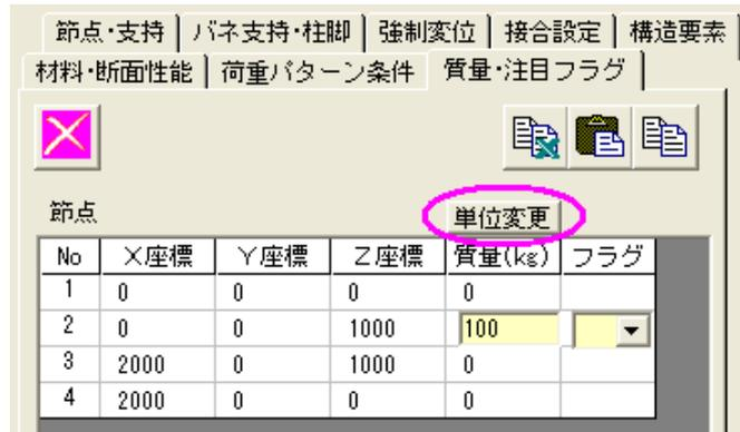
設定方法は節点毎に設定する集中荷重などと同じで設定したい節点の設定欄をクリックしてデータ入力ボックスが表示して質量の入力欄に設定したい節点質量を入力します。単位はデフォルトがk gですが〔フレーム構造解析 1 0〕から〔単位変更〕ボタンが追加されこのボタンをクリックする毎にk gとNが切り替えられるようになっています。ただしNは質量の単位ではありません。この機能では次で説明する加速度の値に関係なく質量1 k gは9. 8 0 6 6 5 Nに変換されて表示されます。
