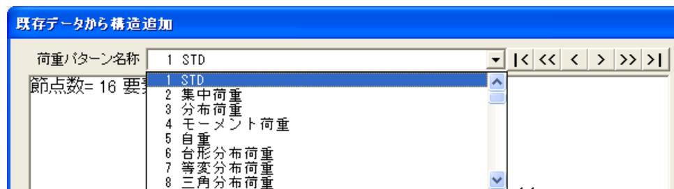
なお“荷重条件を残す”をチェックした場合は元の構造と同じ荷重パターン番号が使われますのであらかじめ荷重パターン条件の使い方、名称等を統一しておくとう便に使用できますが、荷重パターンの設定内容が元の構造と異なる場合はコピー後の修正が面倒になる場合も考えられますのでその場合は“荷重条件を残す”のチェックを外して構造のみコピーしてください。
