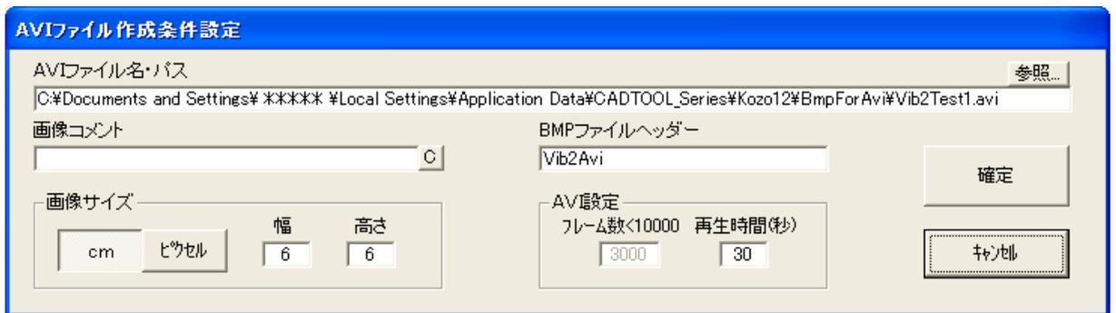
AVIファイル名・パス、画像コメント、BMPファイルヘッダー、画像サイズは振動モード解析で説明したものと同一なのでそちらを参照してください。振動応答解析では解析ステップ数が自動的にフレーム数となりフレーム数の変更はできません。またフレーム数が10000以上のAVIファイルは作成できません。
