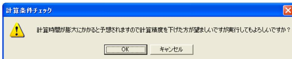
この計算にはXp、P4、2.4GHzで約2分かかりました。マシンの性能にもよりますがこのメッセージが表示された場合は必要に応じて計算精度を変更して計算してみてください。最初は[低]または[最低]の計算精度で試してみると良いでしょう。
