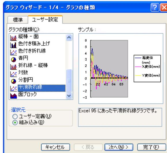
変位応答グラフなので折れ線グラフが良いと思います。ここではユーザー設定から平滑折れ線グラフを選択してみます。Excelのバージョンによって操作が異なるかも知れませんがその場合はExcelのマニュアル等を参照してください。とりあえず細かい設定はしないでここで [完了] ボタンをクリックすると次に示す変位応答グラフが作成されます。
