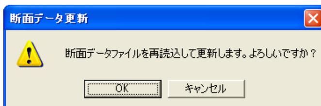
ここで [OK] ボタンをクリックすると断面データファイルを再読み込んで更新します。通常は断面性能計算で断面を登録した場合に使いますが、断面データを直接編集するような場合は編集ミスなどがあると不具合が発生することもありますので材質データと同様に作業中のデータを保存し一旦コマンドを終了してから行ってください。
