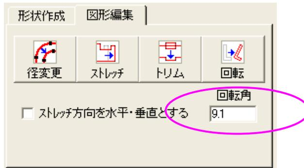
このまま [回転] ボタンをクリックすると主軸方向が水平・垂直方向になるように形状が回転して主軸回りの断面性能を計算することもできます。
