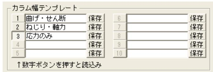
ここで特定の計算結果だけを表示できるようなカラム幅の設定をしておくことでそれだけを計算結果表示欄に表示でき計算結果の確認が容易にできます。次に示したものは応力値のみを表示する設定のものになります。
