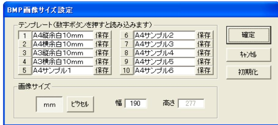
従来は表示されているイメージをそのままのサイズで画像ファイルに出力していましたがメインのダイアログの大きさによってイメージ表示枠の大きさも変わってくるので画像ファイルの大きさもまちまちになっていましたが [フレーム構造解析 10] から画像サイズを任意に設定することができイメージ表示枠の大きさに関係なく決まったサイズでの出力が可能になりました。
