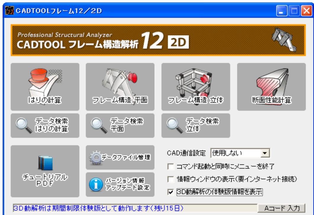
ここで実行したいコマンドの名称が表示してあるイメージにマウスを置くとイメージが暗転するのでその状態でイメージをクリックするとそれぞれのコマンドのウィンドウが開きます。
