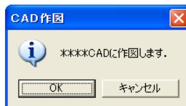
ここで [OK] ボタンをクリックするとCADに作図されます。CAD作図やDXF出力では必要に応じて環境設定の [CAD・DXF出力設定] で画層名や色を設定しておきます。
